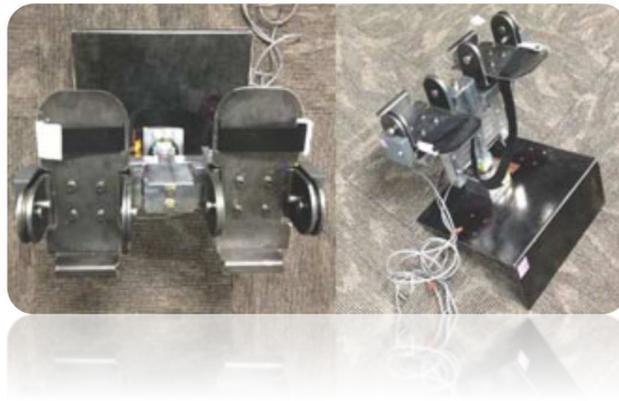
Mediante este sistema es posible enviar señales para que un avión, helicóptero, dron, pueda moverse en las tres dimensiones, usando el operador, solo los pies.
