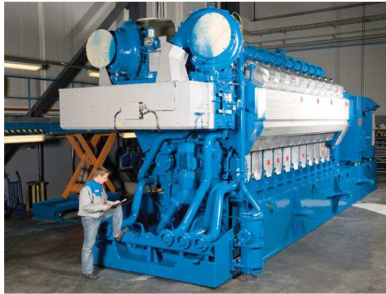
Unidad generadora semejante a las que se instalan en el lago Kivu.
